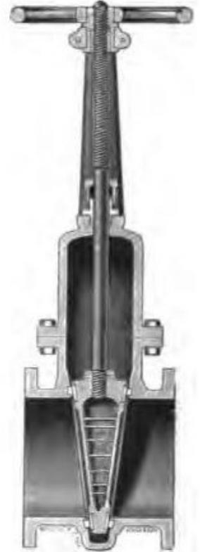
左側の弁:減速ギア付、弁箱、弁体:鋳鉄製、弁棒は内ねじ式管との接続はベル&スピゴット(印籠式)の可能性。流体が蒸気の場合、右側の弁のようにフランジ採用。ボルト孔がないが、まだフランジの規格がなかったので、管側フランジに合わせ、後でボルト孔加工したものと思われる。なお、30年後の1917年発行のCrane社のカタログには、鋳鋼弁が頻出している。
